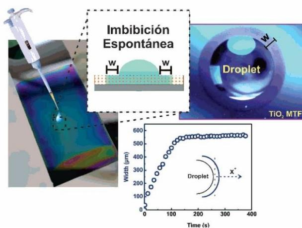
Fig. 1: Seguimiento de la Dinámica de Imbibición Nanofluídica por Microscopía de Luz Visible
